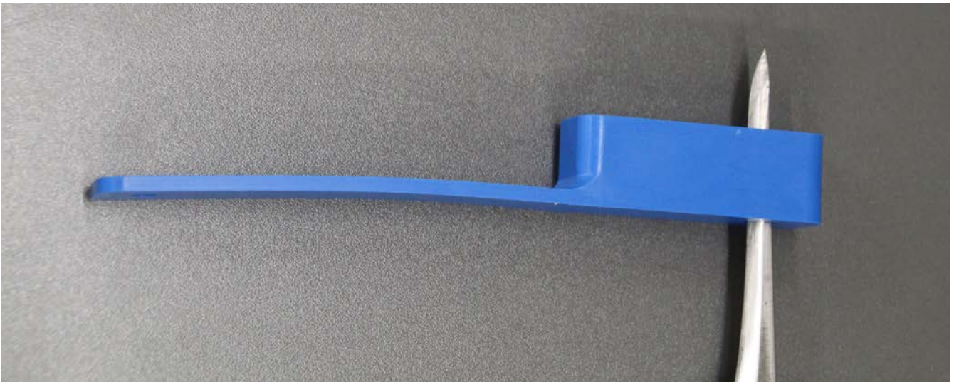
Abb. 19 Eindeutiges Prüfergebnis: Dieses Ausbeinmesser muss entsorgt werden, da die Messerspitze aus der Prüflehre herausragt
